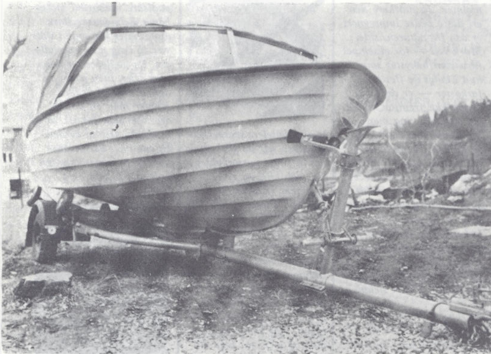
En typisk båttrailer av norsk fabrikk. Denne utgaven tar båter inntil 18 fot og tåler maksimalt 500 kg. Trailerne fås i forskjellige størrelser, utførelser og prisklasser, men under en tusenlapp slipper man neppe før båten kan tas på slep etter bilen.
